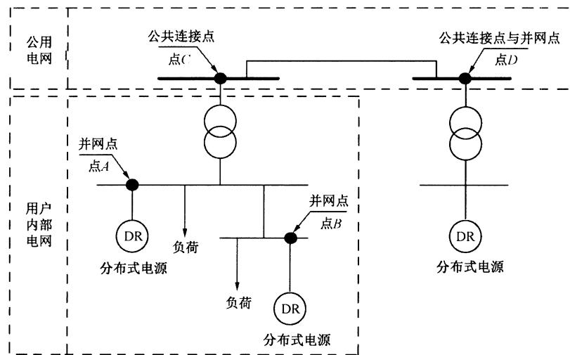
注: 用户电网通过公共连接点 C 与公用电网相连。在用户电网内部,有两个分布式电源,分别通过点 A 和点 B 与用户电网相连,点 A 和点 B 均为并网点,但不是公共连接点。在点 D,有分布式电源直接与公共电网相连,点 D 是并网点,也是公共连接点。
