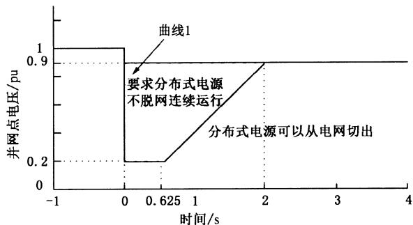
注:各种电力系统故障类型下的考核电压为:三相短路故障和两相短路故障考核并网点线电压,单相接地短路故障考核并网点相电压。
